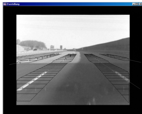
Strichdetektion und Schätzung des Fahrbahnverlaufes
